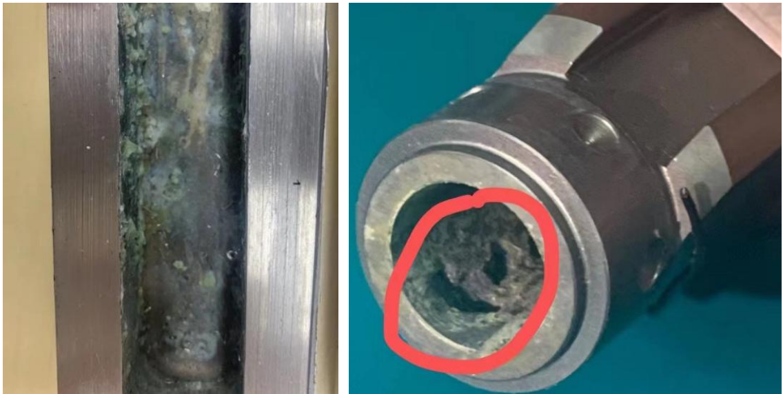
图 9 激光器水道腐蚀图
