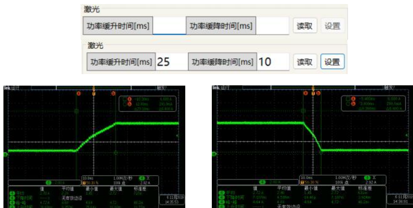
图 34 功率缓升缓降设置区显示界面及实测波形
